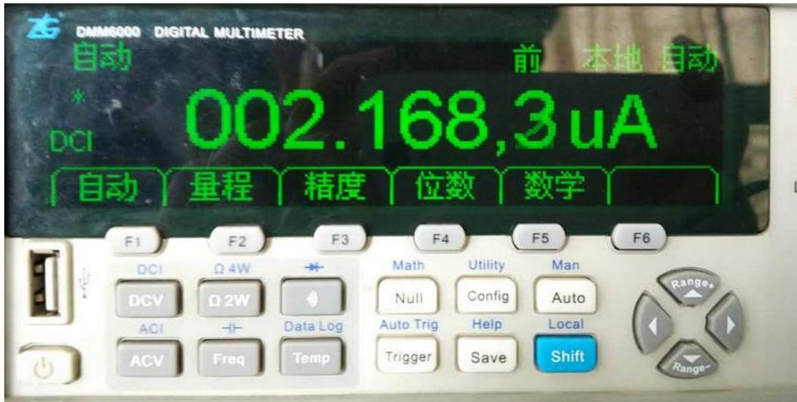
图 1.4 非 DC-DC 模块的 DMM6000 功耗测试结果
