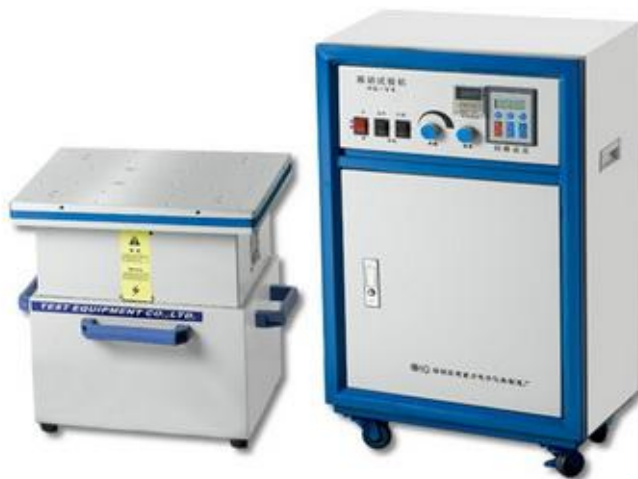
图 2 电磁式振动试验台
