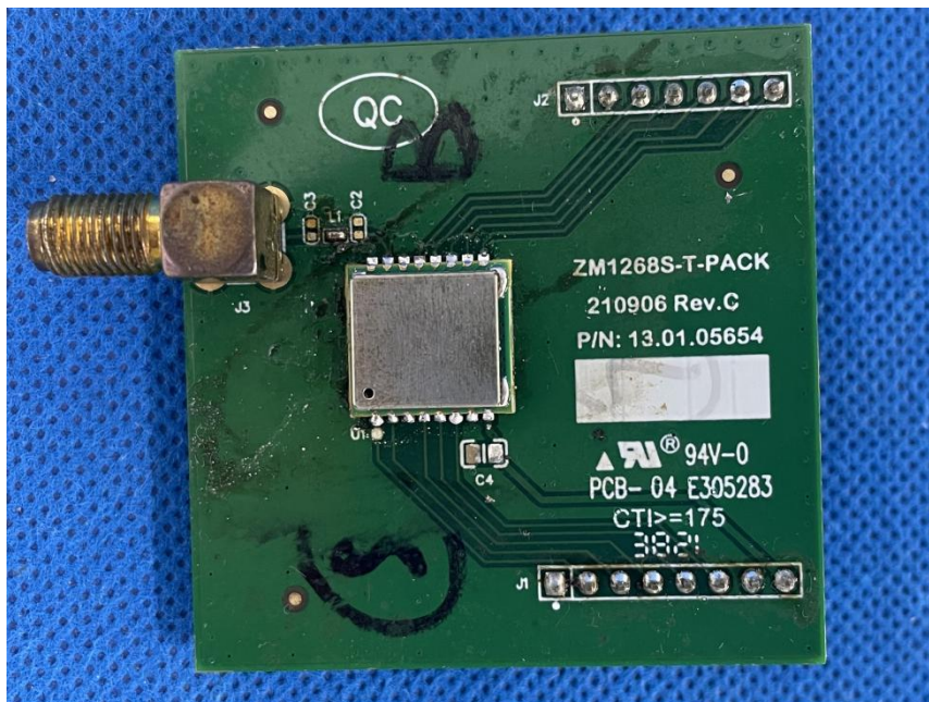
图 4 受试样机 ZM68S-B S0.00 焊接在 ZM1268S-T-PACK 正视图
