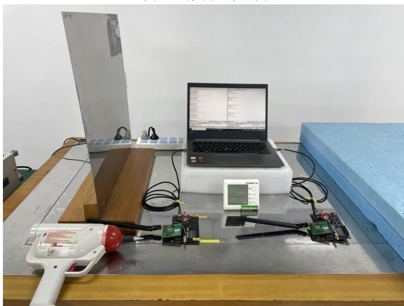
图 2 ESD 试验配置现场图
