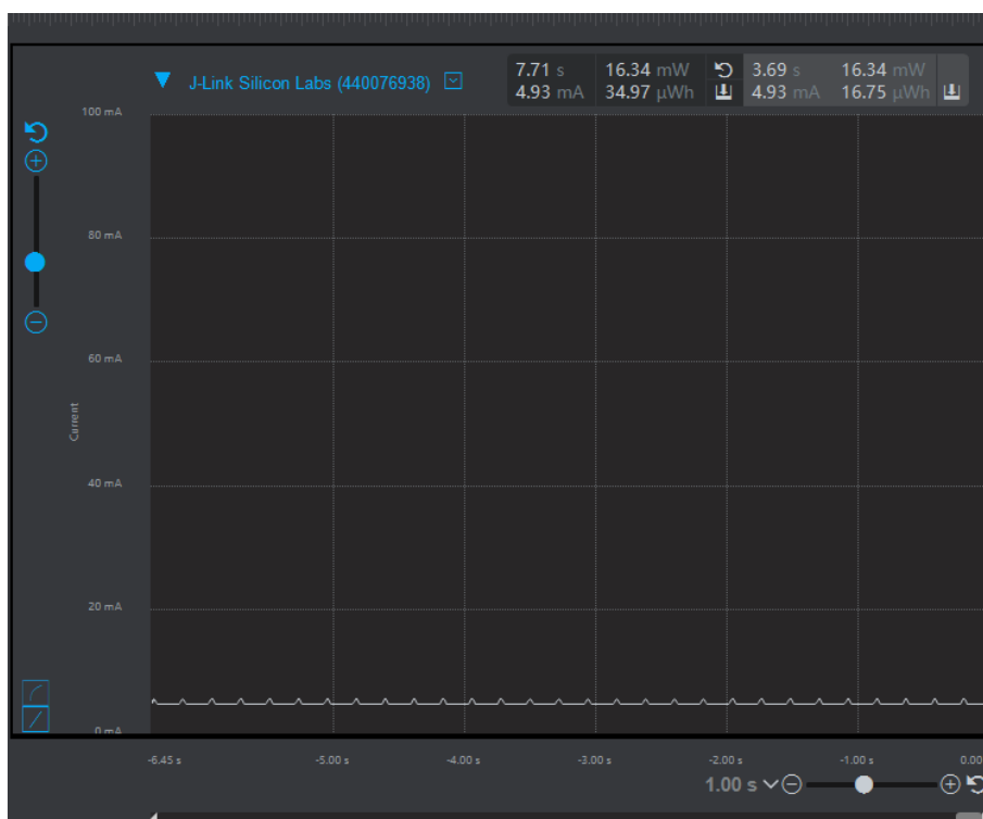
图 3.16 SF=11 BW=500KHz LoRa 接收模式电流
