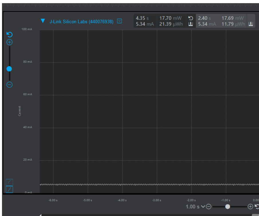
图 3.15 SF=7 BW=500KHz LoRa 接收模式电流
