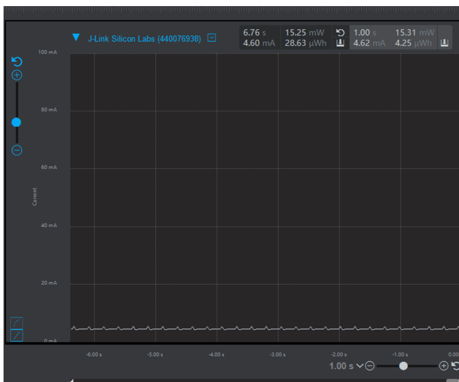
图 3.14 SF=10 BW=250KHz LoRa 接收模式电流
