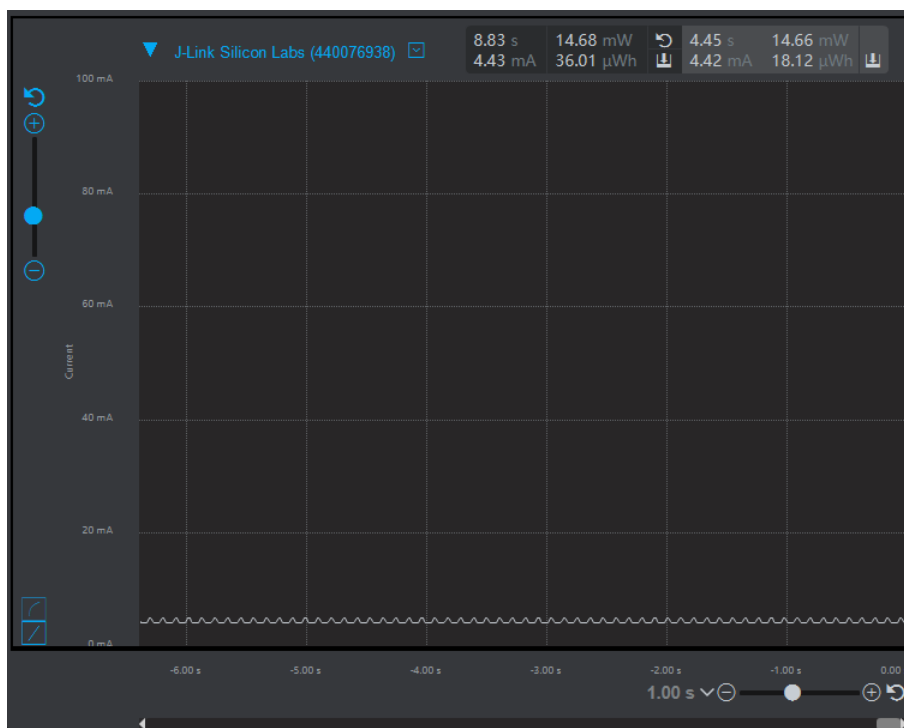
图 3.11 SF=7 BW=125KHz LoRa 接收模式电流
