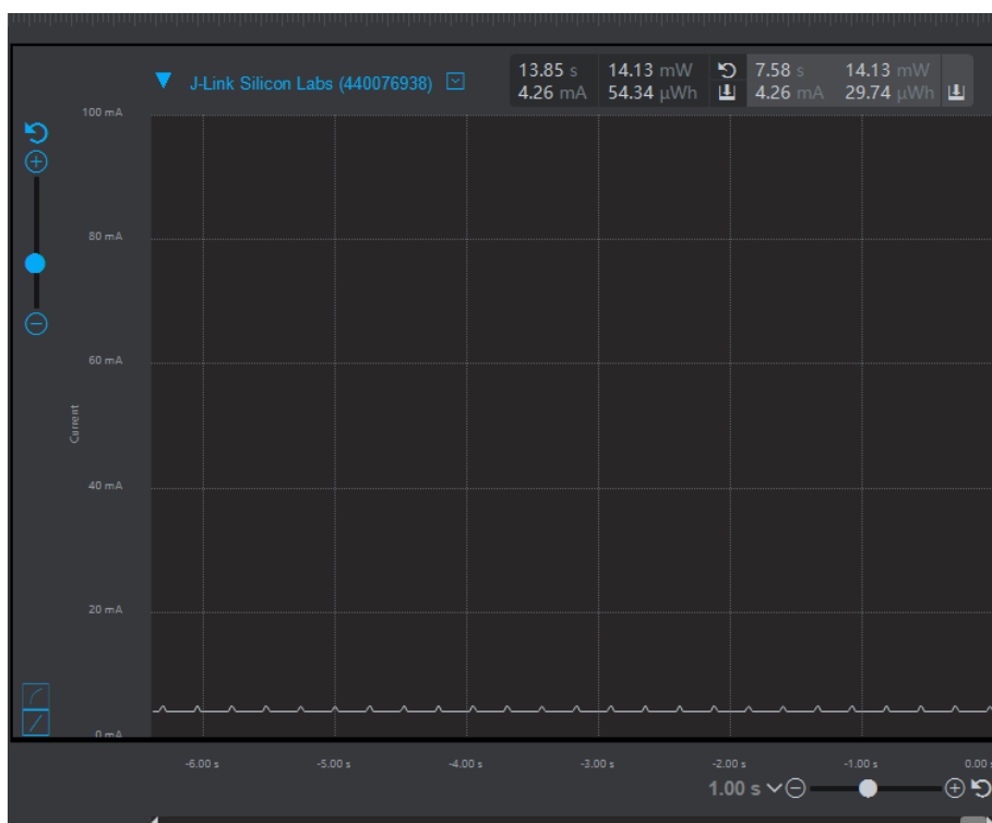
图 3.12 SF=9 BW=125KHz LoRa 接收模式电流
