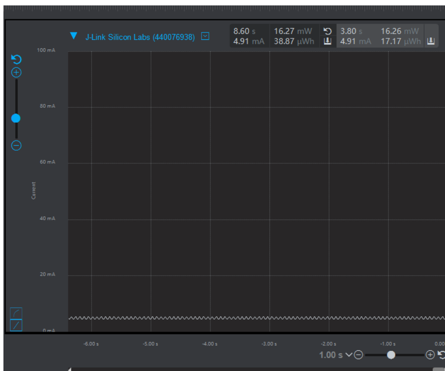
图 3.13 SF=7 BW=250KHz LoRa 接收模式电流
