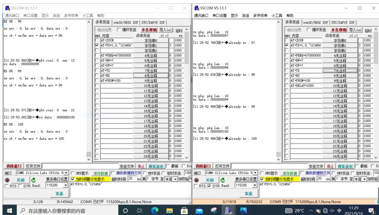
图 11 样机在 -42°C 时功能测试正常
