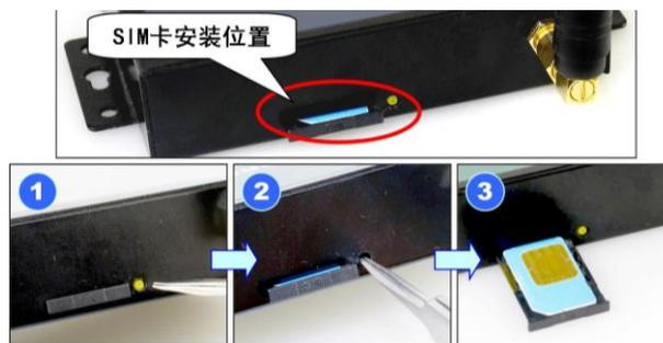
图 3.2 SIM 卡安装
