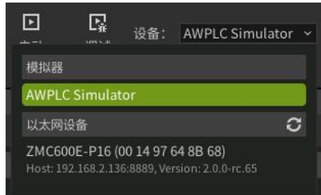
图 4.7 扫描 PLC 控制器
