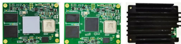
图1 核心板安装散热片
