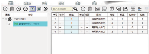
图12 MMS写入转Modbus数据
