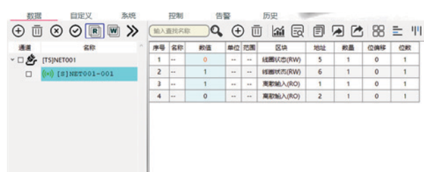
图15 GOOSE发送数据转Modbus
