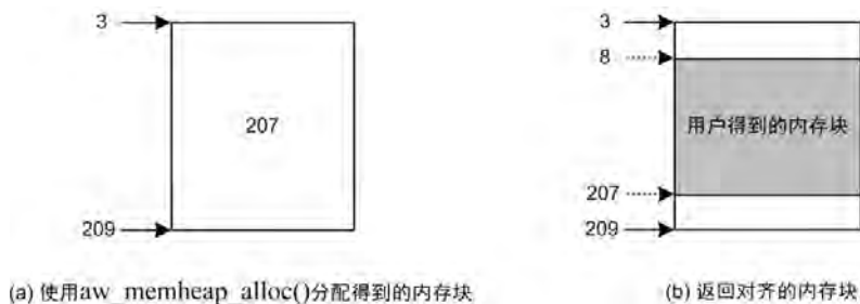
图 9.14 内存对齐的处理——多分配 align-1 字节的空间
